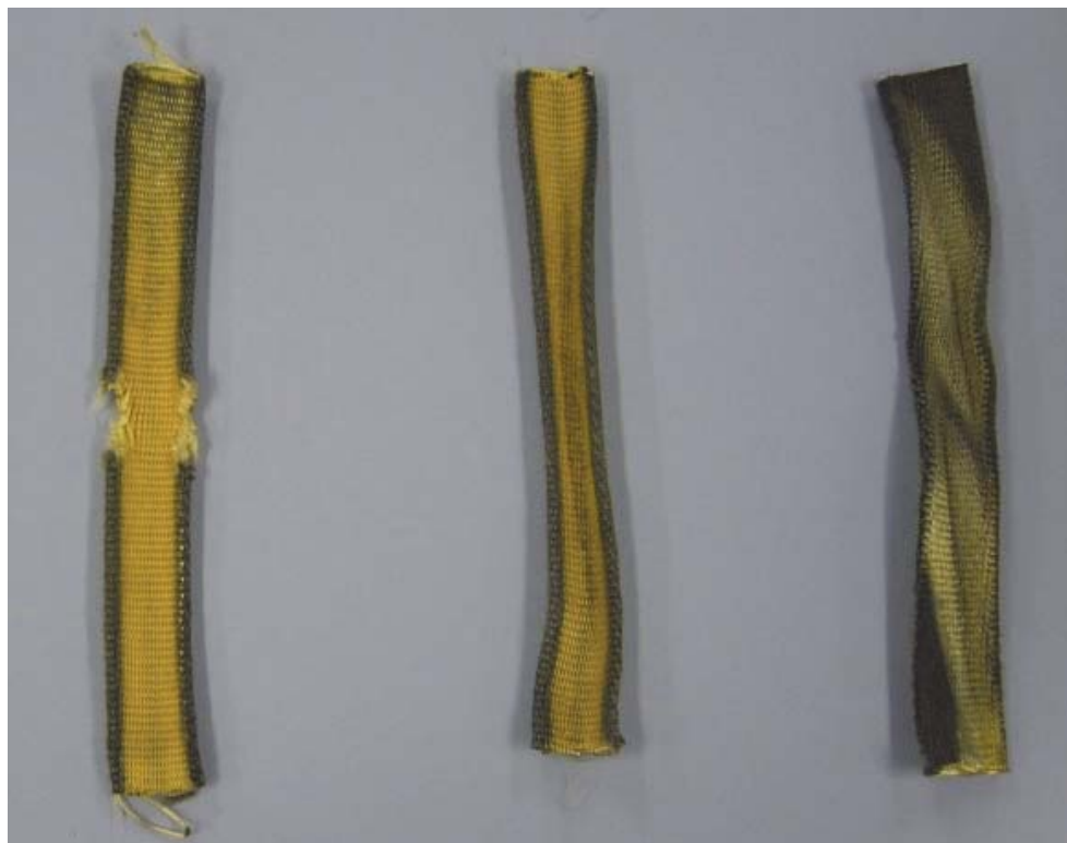
ほつれ・損傷
